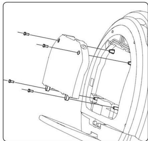
Как показано на рисунке, вставьте верх крышки в специальное отверстие, затем захлопните её снизу.
